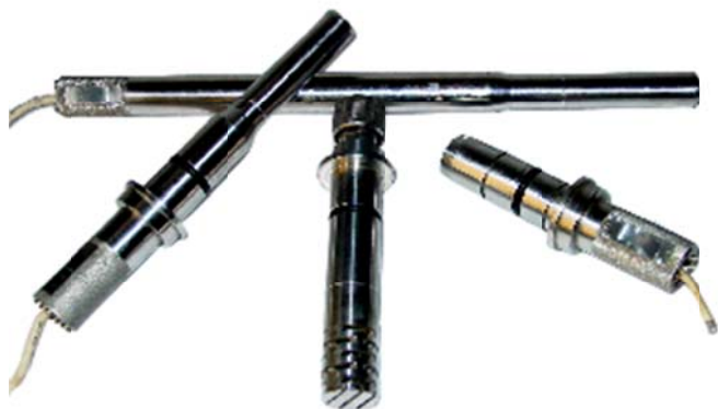
Рис. 3.3. Внешний вид стерилизуемых амперометрических сенсоров АСрН 2 -06
