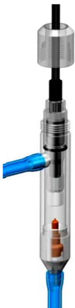
Рис. 3.6. Установка АСрН 2 в измерительную камеру.
